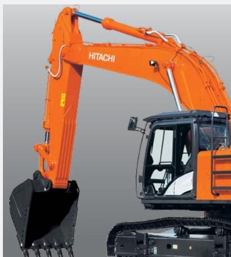
Усиление конструкции стрелы и рукоятки при комплектации скальным ковшом
