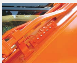
Централизованные точки смазки узлов стрелы и рукоятки
