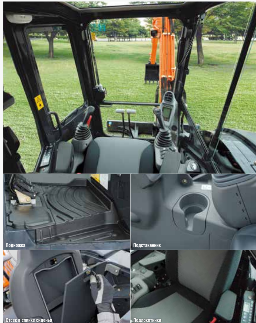
Показан экскаватор в комплектации с кабиной, амортизированным сиденьем, подлокотниками, радиоприемником FM/AM диапазонов, с рычагом управления дополнительным навесным оборудованием, кондиционером и педалью, поставляемыми в качестве опции.
