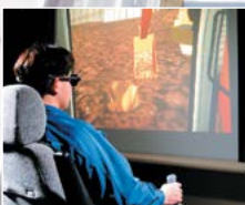
Испытание, имитирующее нахождение оператора на сиденье
