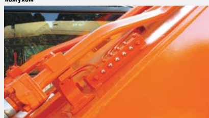
Точки централизованного смазывания шарниров стрелы и рукояти
