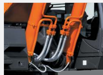
Защита шлангов гидроцилиндров стрелы
