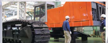
Линия сборки крупных экскаваторов
