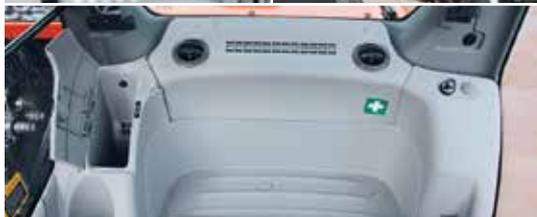
Прочная кабина, соответствующая требованиям OPG (верхняя защитная конструкция уровня 1), защищает оператора от падающих сверху предметов. Система защиты от опрокидывания (ROPS) создана для защиты оператора на случай опрокидывания экскаватора (устанавливается по заказу). Рычаг блокировки системы гидроуправления оснащен системой нейтрального пуска двигателя, которая позволяет запустить двигатель только тогда, когда данный рычаг находится в положении «Заблокировано».
