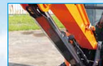
Защитное ограждение гидроцилиндра стрелы Защитное ограждение гидроцилиндра имеет прочную форму в виде перевернутой буквы V.
