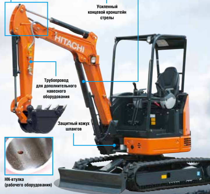
Защитное ограждение гидравлических шлангов Шланг ковша закрыт защитным ограждением во избежание его зацепления и повреждения.
