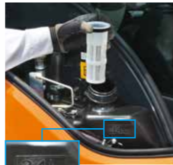
Промаркирована максимальная вместительность топливного бака.
