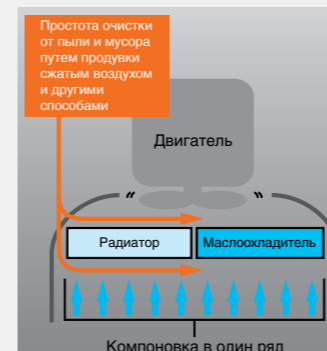
Расположение радиатора и маслоохладителя в один ряд
