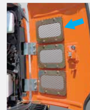
Внутренняя пылезащитная сетка (опция)
