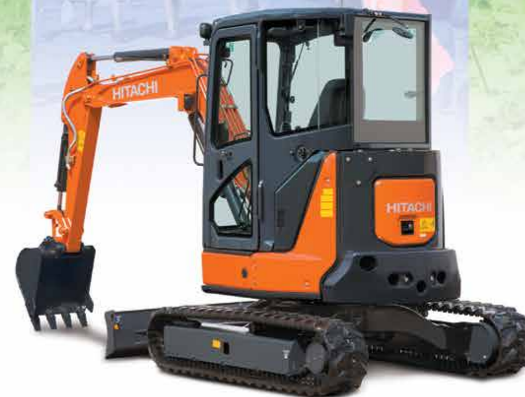
Показан экскаватор в комплектации с рукоятью длиной 1,52 м, дополнительным противовесом, кабиной и гидроразводкой для дополнительного навесного оборудования, поставляемыми в качестве опции.
