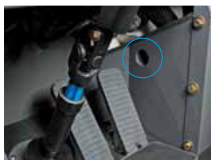
Новые дефлекторы в зоне ног
