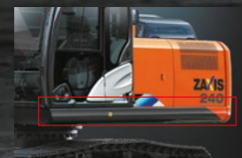
Боковые лонжероны D-образного сечения
