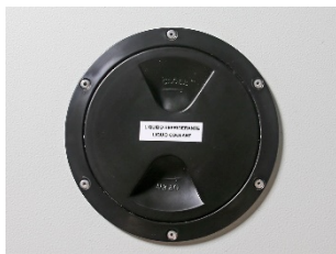
Крышка заливной горловины радиатора снаружи фонаря
