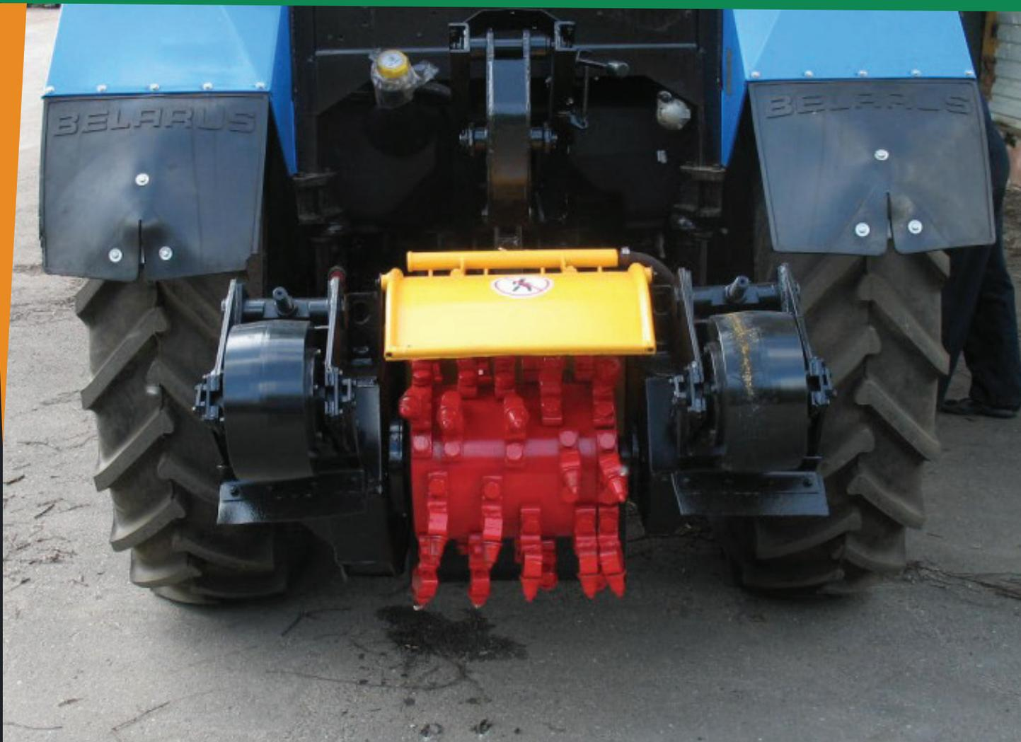
Фреза дорожная ФД-567 предназначена для подготовки асфальтовых и бетонных дорожных покрытий (без арматуры) к ремонту методом холодного фрезерования (удаление поврежденного дорожного покрытия, выступов, неровностей и т.п.). ФД-567 представляет собой навесное оборудование, установленное на тракторе совместно с гидроходоуменьшителем и системой охлаждения фрезы. Оборудование может эксплуатироваться при температуре окружающей среды от +5 до +40 С.
