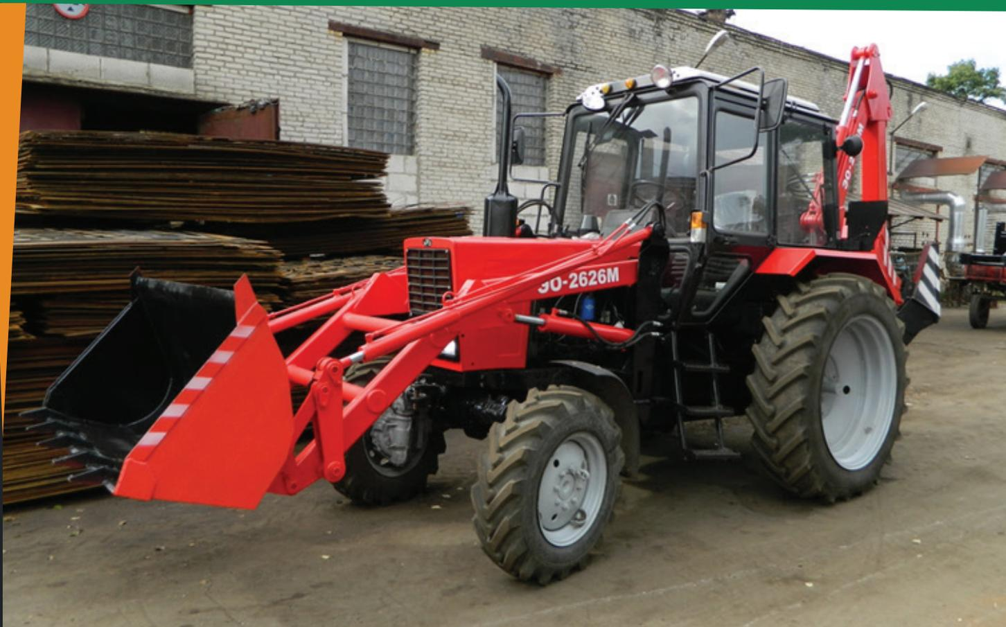
Экскаватор ЭО на базе трактора МТЗ-82.1 используется для выполнения следующих работ:
