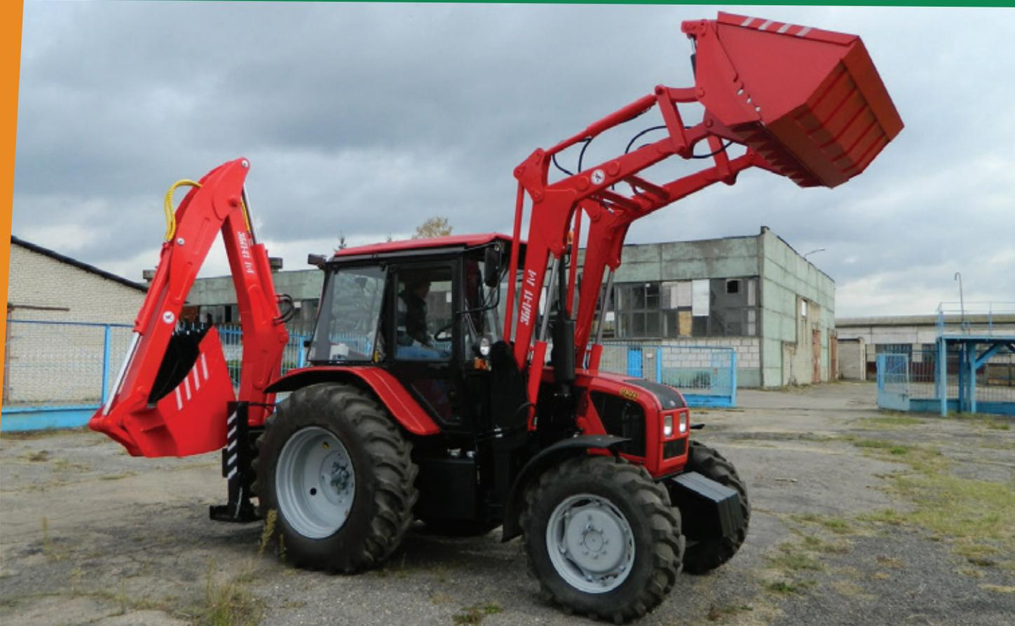
Экскаваторы с бульдозерно-погрузочным оборудованием серии ЭБП-11 М предназначено для производства земляных работ, а также погрузки или разгрузки сыпучих материалов.
