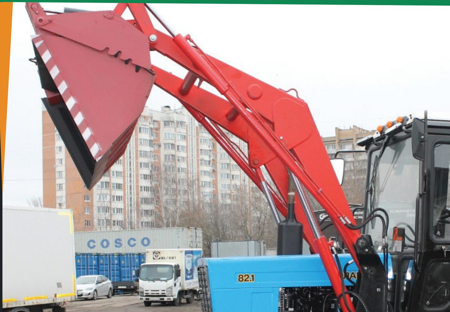
Погрузчик ПФН-0,38М (КУН) предназначен для всех видов погрузочных работ в сельском и коммунальном хозяйстве (погрузочно-разгрузочных работ малого объема, транспортирования сыпучих материалов на небольшие расстояния). Погрузочное оборудование оснащено быстросменом что позволяет производить замену рабочего органа погрузчика в течении 2-3 минут.
