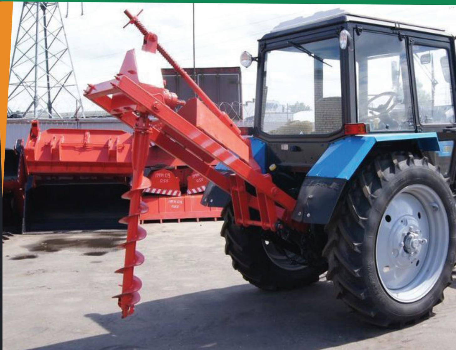
Навесная буровая установка НБУ-1300 используется для бурения отверстий круглого сечения в мягких грунтах на глубину до 1.3 метра
