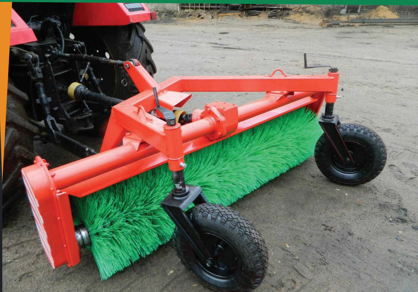
Щеточное оборудование для трактора «БУРАН 25» предназначена для уборки дорог, тротуаров, проезжей части улиц, а также производственных территорий от мусора, песка или свежеснега. В щеточном оборудовании «БУРАН 25» используются более мощные профили, усиленная рама и опорные колеса с упорными подшипниками.
