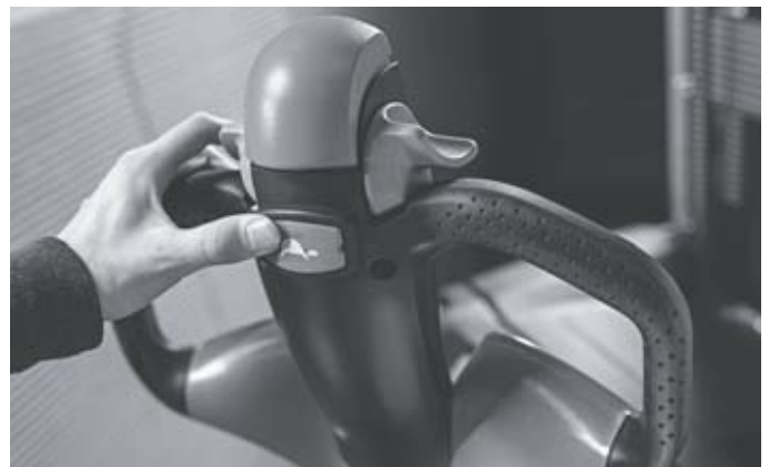
Точность в любой ситуации: с помощью режима медленного хода возможно маневрирование даже в узких помещениях
