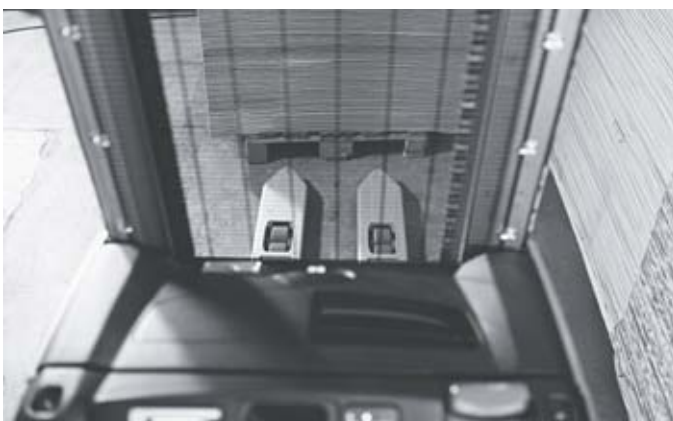
Постоянный хороший обзор кончиков вилок благодаря просматриваемой подъемной мачте STILL
