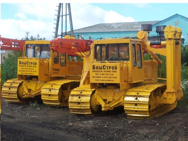
2. **Копрово-буровые установки КБУРГ (12; 14; 16) на базе шасси гусеничных экскаваторов** , используется в промышленном и гражданском строительстве для погружения (забивки) от 12 до 16 метровых железобетонных, металлических свай, устройства скважин строительного назначения, а также проведения шпунтовых работ при выполнении фундаментных работ в строительстве.
