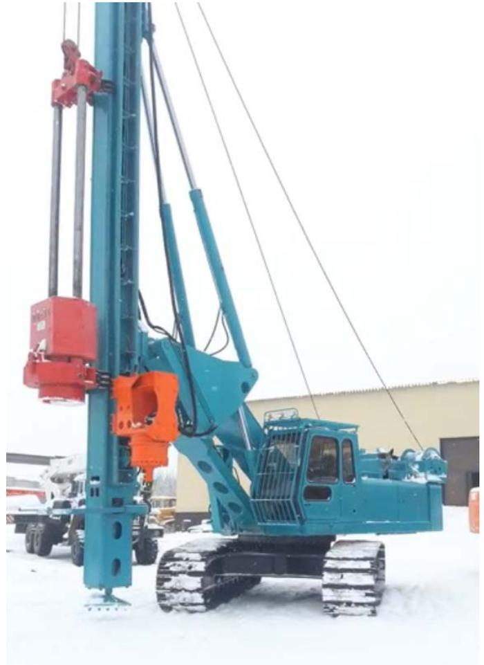
3. **Копрово-бурильные мачты серии МК и SPM**, предназначены для расширения технологических возможностей гусеничных кранов типа ДЭК, МКГ, РДК. На мачту навешивается погружатель для забивки вертикальных свай длиной до 16 м в соответствии с технической характеристикой базовой машины, а так же при применении приводов БО-2, БО-3 используется для бурения скважин диаметром до 1000 мм., глубиной до 16 м.
