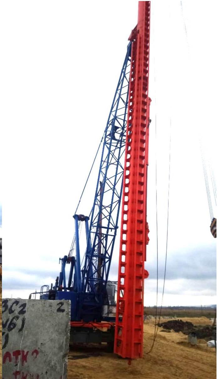
4. **Бурильное оборудование БО-2Г (гидропривод) и БО-2Э (электропривод)** предназначено для бурения скважин под буронабивные сваи в устойчивом грунте и лидирующих скважин под забивные сваи.
