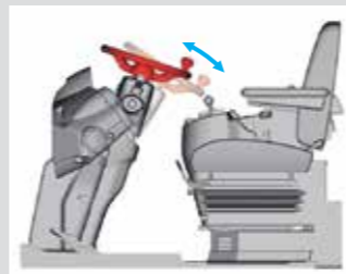
Рулевое колесо с регулируемым углом наклона
