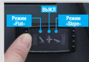
Переключатель режимов отключения фрикционов
