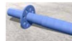
устанавливается на становочную пяту. Данный элемент необходим для начала монтажа лесов и служит для установки вертикалей (как «подставка»). Имеет фланец для крепления горизонталей с соседними аналогичными элементами, что дает возможность обвязывать леса горизонталями на малой высоте (которая выставляется становочной пятой).
