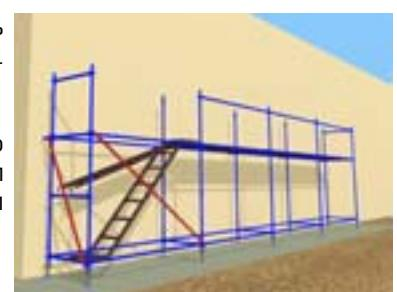
7. Установить стеновую опору между конструкцией и обрабатываемой поверхностью
