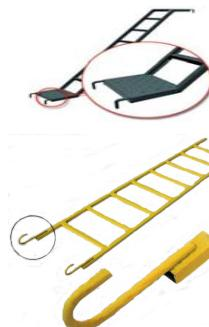
Лестница выполнена из стали. Лестница устанавливается по диагонали под углом 45° на высоту 2м и крюками крепится за поперечные горизонтали. Стальная лестница выдерживает нагрузку 250-500кг.
