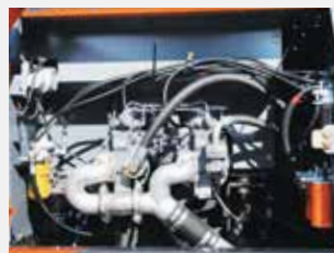
Сгруппированные в одном месте фильтры и точки ежедневной проверки
