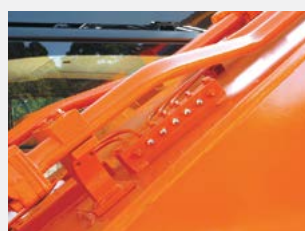
Точки централизованного смазывания шарниров стрелы и рукояти
