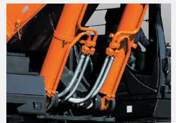
Защита шлангов гидроцилиндров стрелы
