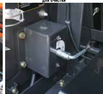
Выключатель аккумуляторной батареи
