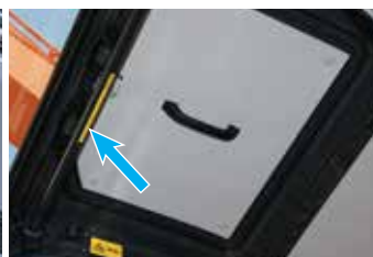
Фиксатор лобового стекла, открываемый одним движением
