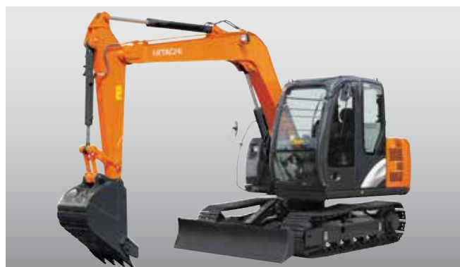
Примечание: изображенный на рисунке ZX70 оснащен дополнительным отвалом
