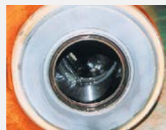
Термическое напыление WC (карбид вольфрама)
