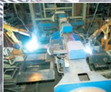
Линия сварки основной рамы
