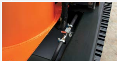
Кран для слива осадка из топливного бака
