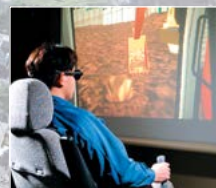
Испытание методом моделирования с сиденья оператора
