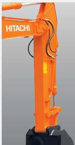
Основные трубопроводы рабочего оборудования
