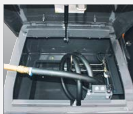
Электрический топливозаправочный насос
