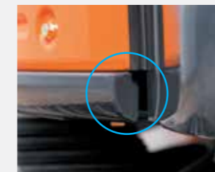
Боковые лонжероны D-образного сечения
