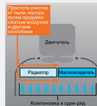
Расположение радиатора и маслоохладителя в один ряд
