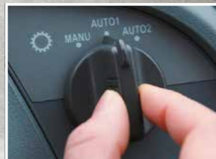
Переключатель диапазонов скоростей хода
