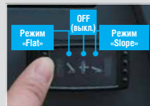
Переключатель режимов отключения фрикционов
