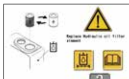
Предупреждение о засорении масляного фильтра гидравлической системы
