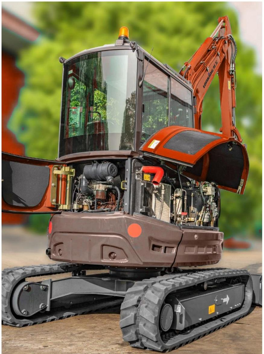
Задний и правый капот могут быть полностью открыты для обеспечения простого и удобного планового осмотра, технического обслуживания и замены фильтров. Конструкция гидрораспределителя очень удобна для обслуживания и ремонта, не требует снятия закрывающих деталей.
