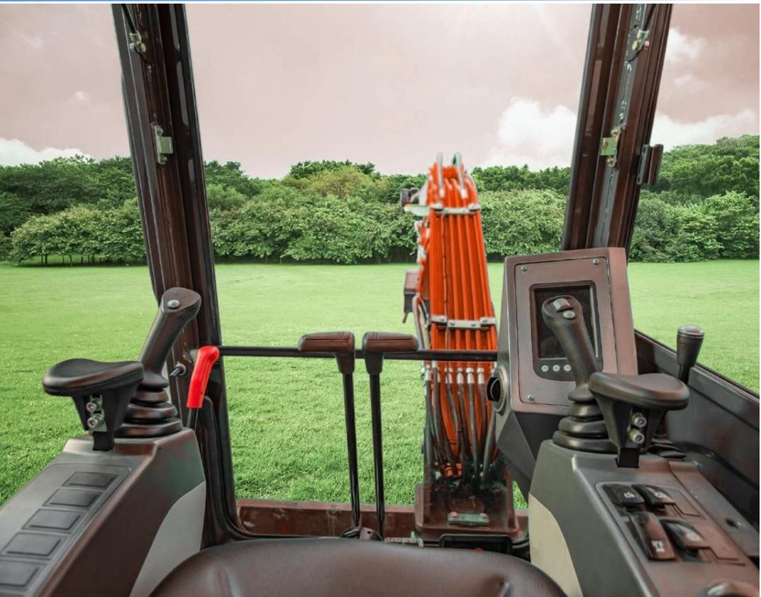
Более широкое пространство для оператора и обзорность обеспечиваются увеличенным передним ветровым стеклом и люком. Кроме того в стандартную комплектацию входят кондиционер, плавающее амортизирующее сиденье, сенсорное радио и стереосистема.
