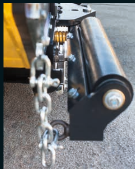
Защита от удара при стыковке самосвала благодаря подпружиненным сдвигаемым роликам.
