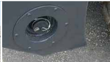
Система быстрой заправки топливом.
