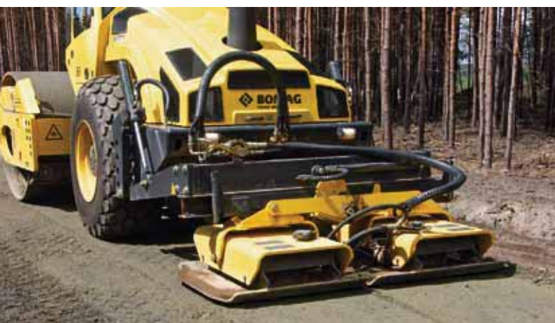
Для превосходной поверхности: BW 213 DH с навесными плитами.
