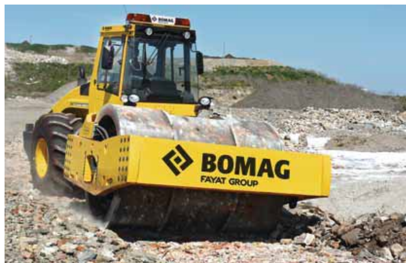
BOMAG BW 332 – самый мощный грунтовый каток в мире.
