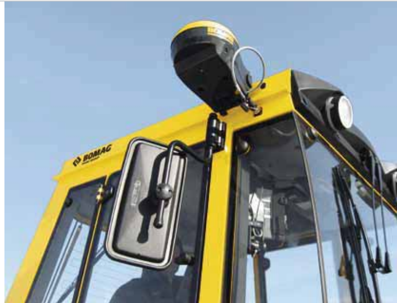
Повсеместное применение: GPS-приемник StarFire фирмы BOMAG.
