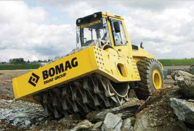
Скальный валец для скальных пород мягкой и средней твердости.
