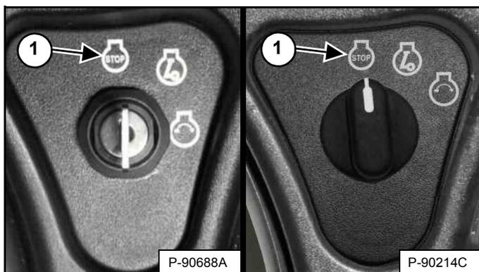
Поверните ключ в положение STOP (СТОП) (1) [Рис. 126].
