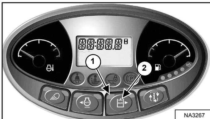
Однократно нажмите кнопку "Вкл/Выкл" системы вспомогательной гидравлики (2) [Рис. 86] для ее включения.
