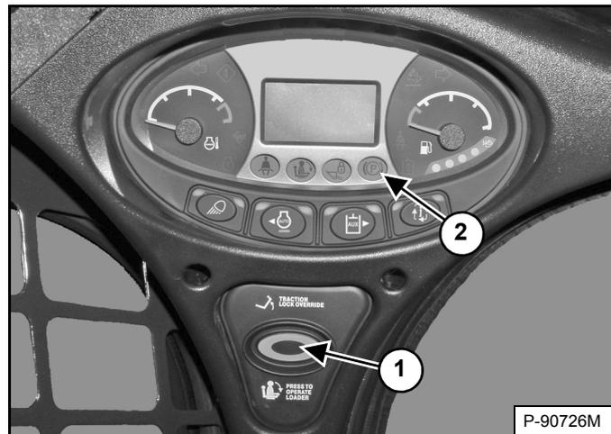
*(Работает только при поднятой раме безопасности и работающем двигателе)* На левой приборной панели имеется кнопка **TRACTION LOCK OVERRIDE (УПРАВЛЕНИЕ ПРИ БЛОКИРОВКЕ ТЯГИ)** (1) [Рис. 35], которая позволяет использовать рычаги управления движением для перемещения погрузчика вперед и назад при использовании обратной лопаты.
