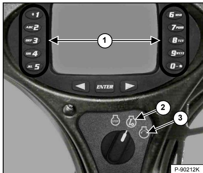
Поверните ключ в положение RUN (РАБОТА) (2) [Рис. 120]. Индикаторы на левой приборной панели загорятся на короткое время, и приборная панель и система контроля работы погрузчика выполнят самопроверку.
