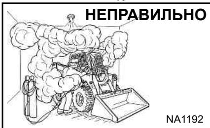
⚠ При сварке или шлифовке окрашенных деталей обеспечьте достаточную вентиляцию.
