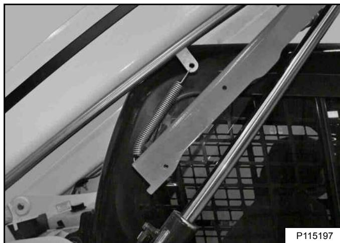
Немного поднимите стрелу. Пружина приподнимет упор стрелы над штоком цилиндра подъема стрелы [Рис. 184]. Полностью опустите подъемные рычаги.
