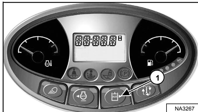
Нажмите кнопку "Вкл/Выкл" системы вспомогательной гидравлики (1) [Рис. 91].
