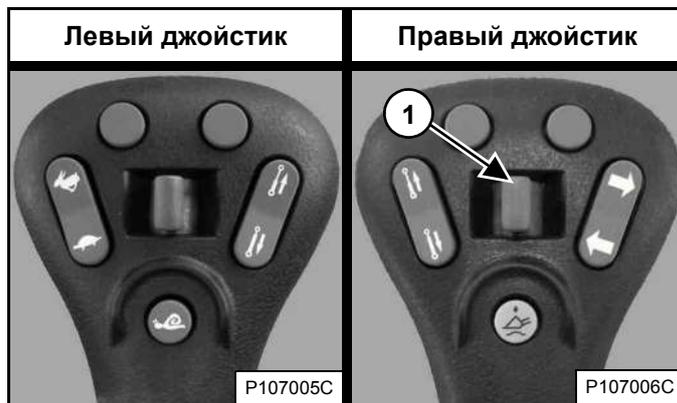
Переместите переключатель передней доп. гидравлики (1) [Рис. 82] или [Рис. 83] вправо или влево для изменения направления подачи масла в быстроразъемные муфты передней доп. гидравлики. Если сдвинуть переключатель доп. гидравлики наполовину, то функции доп. гидравлики будут выполняться приблизительно на вдвое меньшей скорости. (ПРИМЕР: открытие и закрытие челюстей грейфера.)
