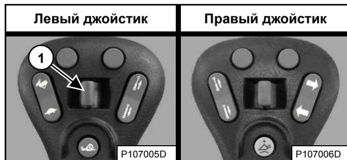
Несколько раз сдвиньте переключатель системы задней вспомогательной гидравлики (1) [Рис. 92] или [Рис. 93] влево и вправо. Поверните ключ в положение STOP (СТОП).
