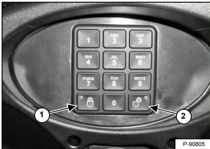
Нажмите клавиши блокировки (1) и разблокировки (2) [Рис. 305] и удерживайте их в течение двух секунд.
