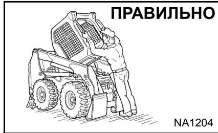
⚠ Соблюдайте правильный порядок подъема и опускания кабины оператора.
