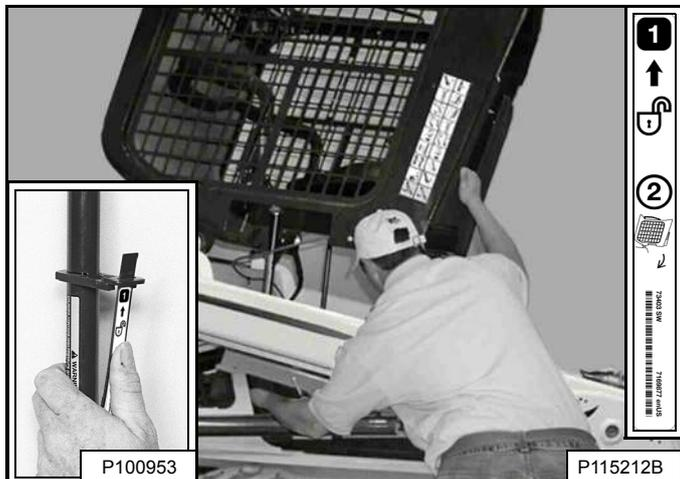
Потяните кабину оператора за нижнюю часть до тех пор, пока ее не остановит фиксирующий механизм [Рис. 195].
