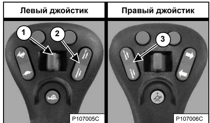
Дополнительные переключатели (1, 2 и 3) [Рис. 96] или [Рис. 97] используются для управления некоторыми функциями навесного оборудования с помощью устройства управления навесным оборудованием.
