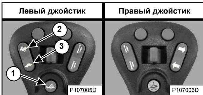
Установить более высокое (2) или более низкое (3) значение скорости [Рис. 65] можно, нажимая переключатель скоростей до достижения нужного значения.
