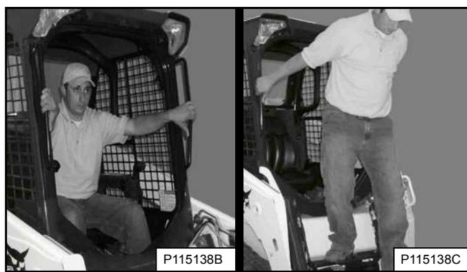
При выходе из кабины пользуйтесь ступеньками, подножками и поручнями (должны обеспечиваться 3 точки опоры) [Рис. 127].
