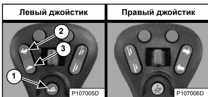
Для включения управления скоростным режимом нажмите кнопку (1) [Рис. 63] на левом джойстике.
