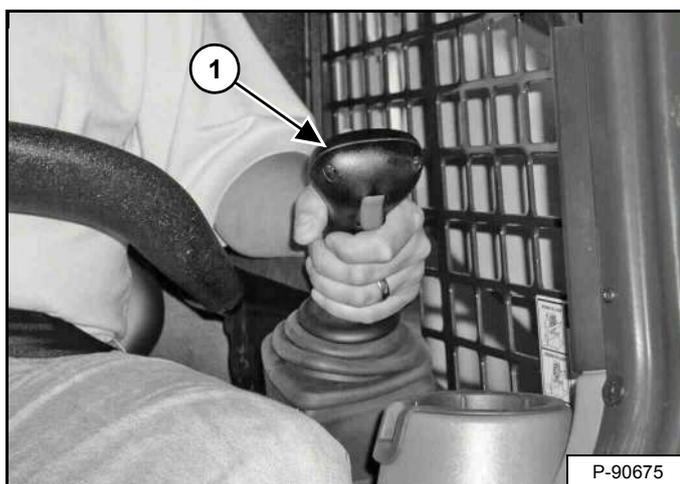
Джойстик, управляющий движением и маневрированием погрузчика, расположен перед сиденьем оператора слева (1) [Рис. 56].
