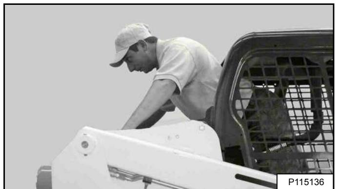
Выйдите через задний проем кабины оператора [Рис. 43].
