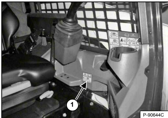
Проверьте наличие и целостность предупреждающей таблички звуковой сигнализации заднего хода (1) [Рис. 186]. При необходимости замените.
