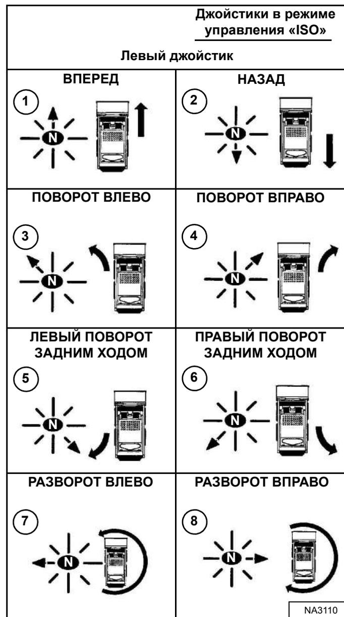
Функции левого джойстика (движение и маневрирование) [Рис. 57]:
