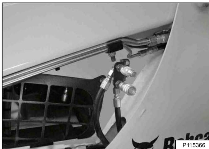
Сдвиньте переключатель задней вспомогательной гидравлики (1) [Рис. 87] или [Рис. 88] вправо или влево для изменения направления подачи масла системы задней вспомогательной гидравлики в быстроразъемные муфты [Рис. 89]. (Показана левая сторона) (ПРИМЕР: Подъем и опускание задних стабилизаторов.) Отпустите переключатель, чтобы выключить подачу масла.
