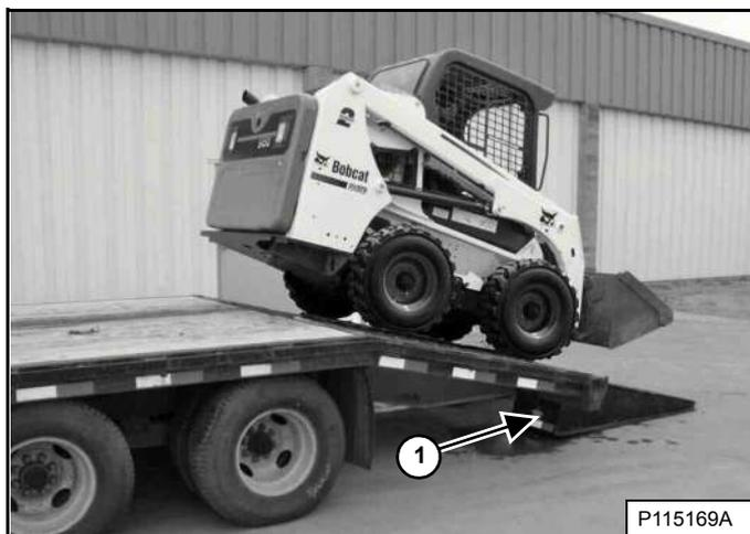
Погрузчик с пустым ковшом или со снятым навесным оборудованием грузится на транспортную платформу, двигаясь задним ходом [Рис. 173].
