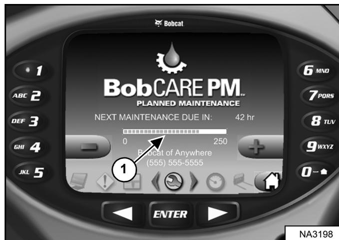
На приборной панели Deluxe (при наличии) будет высвечиваться окно сообщения (1) [Рис. 308] о времени, оставшемся до следующего обслуживания. Если техобслуживание не было произведено вовремя, будет высвечиваться окно красного цвета. [NEXT MAINTENANCE DUE] [(ВРЕМЯ СЛЕДУЮЩЕГО ТЕХОБСЛУЖИВАНИЯ)] изменится на [MAINTENANCE PAST DUE] [(ПРОСРОЧЕННОЕ ВРЕМЯ ТЕХОБСЛУЖИВАНИЯ)], и будет отображаться количество просроченных часов.
