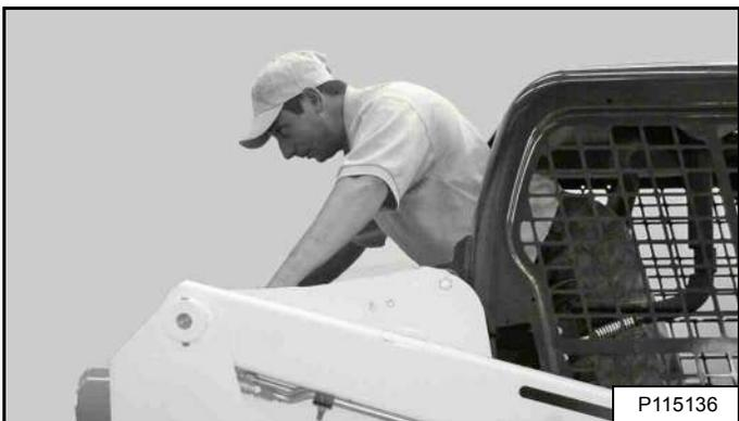
Выйдите через задний проем кабины оператора [Рис. 41].
