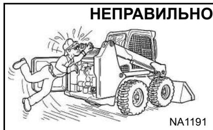
⚠ Держитесь на расстоянии от движущихся частей, электрических контактов, горячих частей и системы выпуска отработавших газов, а также избегайте соприкосновения с ними бижутерии и одежды.
