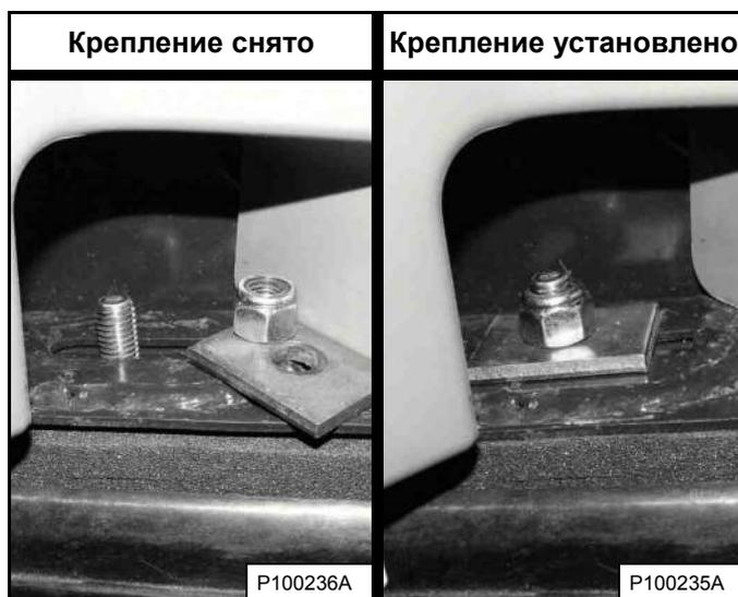
Установите на место шайбы и гайки (с обеих сторон) [Рис. 196].
