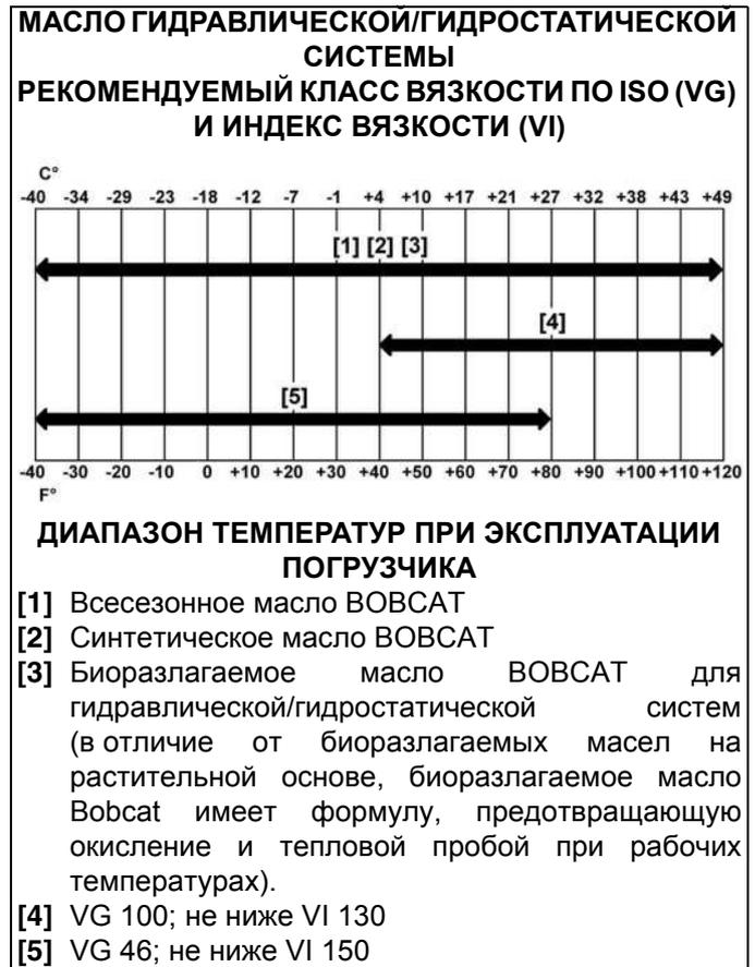
Для использования в этой машине рекомендуются гидравлические масла Bobcat. Если гидравлическое масло Bobcat не доступно, используйте гидравлическое масло хорошего качества, класс вязкости и индекс вязкости которого соответствуют указанным в таблице [Рис. 251].
