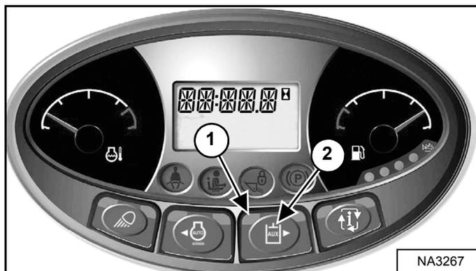
Однократно нажмите кнопку доп. гидравлики (2) [Рис. 81] для включения доп. гидравлики.
