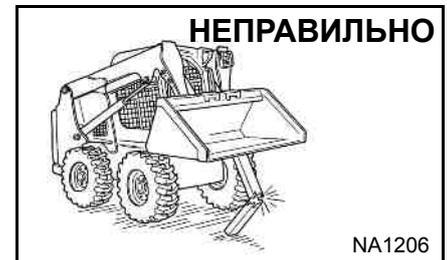
⚠ Запрещается работать на погрузчике с поднятой стрелой, если стрела не поддерживается допущенным к эксплуатации упором стрелы. В случае повреждения замените.
