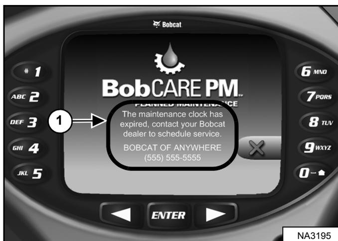
На приборной панели Deluxe (при наличии) будет высвечиваться сообщение (1) [Рис. 307] о необходимости проведения обслуживания машины.
