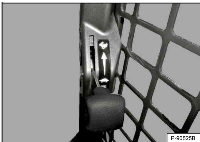
Установите рычаг управления оборотами двигателя в положение низких оборотов холостого хода [Рис. 109].
