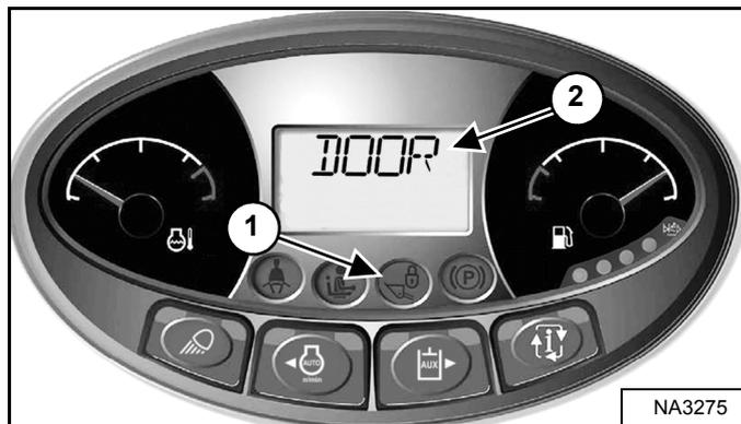
Индикатор LIFT AND TILT VALVE (КЛАПАН ПОДЪЕМА СТРЕЛЫ И НАКЛОНА КОВША) (1) [Рис. 191] ВЫКЛЮЧЕН, когда дверь закрыта, ключ находится в положении RUN (РАБОТА), рама безопасности опущена и кнопка PRESS TO OPERATE LOADER (ВКЛЮЧЕНИЕ ПОГРУЗЧИКА) нажата.
