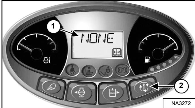
Нажмите кнопку ИНФОРМАЦИЯ (2) для прокрутки ДИСПЛЕЯ ДАННЫХ (1), [Рис. 302] пока не отобразится экран служебных кодов. Если служебных несколько, то они будут отображаться на дисплее данных один за другим.
