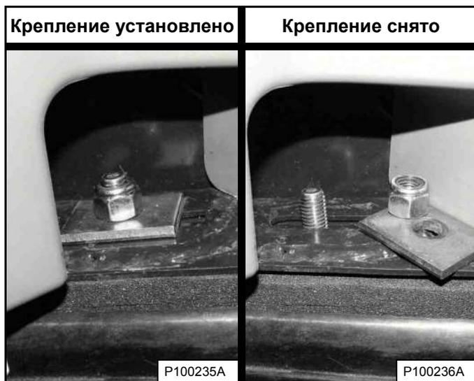
Отверните гайки и шайбы [Рис. 193], которые находятся в передних углах кабины оператора с обеих сторон.
