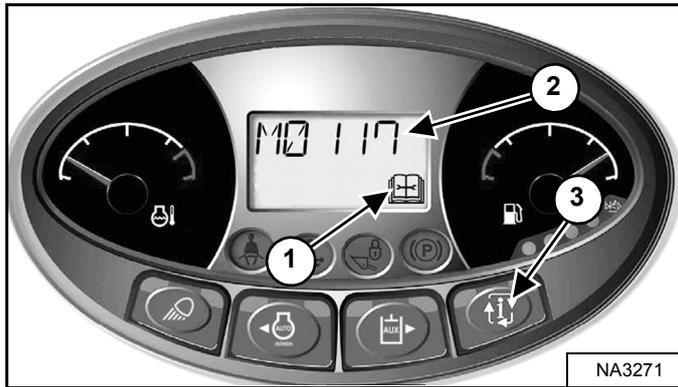
Заменяйте воздушные фильтры только по мере необходимости. Служебный индикатор (1) будет МИГАТЬ. Нажмите кнопку информации (3), удерживая ее до тех пор, пока на экране дисплея не отобразятся служебные коды. Служебный код **[M0117]** (Засорен воздушный фильтр) отобразится на дисплее (2) [Рис. 211] при необходимости замены воздушного фильтра.
