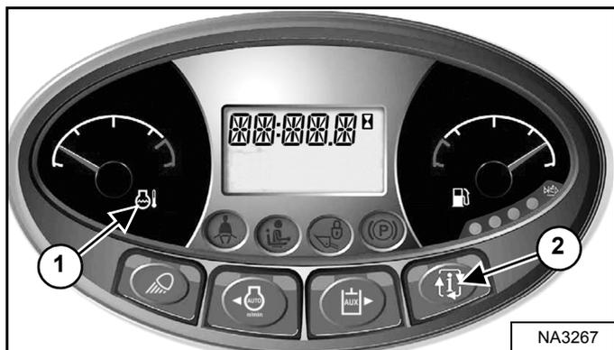
Регулярно проверяйте датчики температуры и уровня топлива и индикаторы системы BICS (для работы погрузчика все индикаторы BICS™ должны быть выключены) [Рис. 124].
