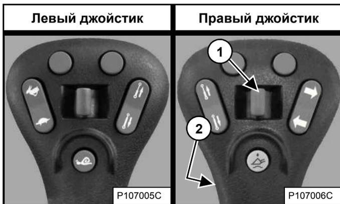
После активирования доп. гидравлики нажмите переключатель непрерывной подачи (2) [Рис. 84] или [Рис. 85], чтобы обеспечить постоянную подачу масла на охватывающую часть муфты передней доп. гидравлики (охватывающая часть муфты находится под давлением). (ПРИМЕР: использование обратной лопаты.)
