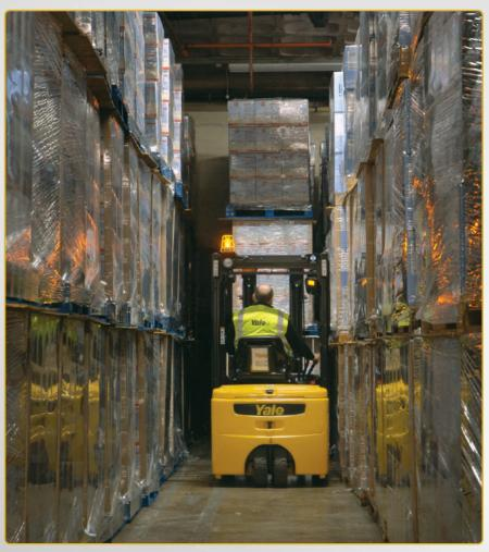
Максимальные скорость и ускорение достигаются при выборе программы 4, а при необходимости более точного маневрирования и увеличения времени работы аккумуляторной батареи без подзарядки, идеально подходит программа 1. Технический специалист также имеет возможность менять максимальную скорость и ускорение в программе 4, при этом, настройки программ 1, 2 и 3 поменяются автоматически, в определённом процентном отношении к параметрам программы 4.
