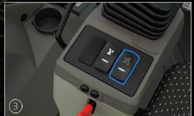
Кнопка переводного механизма для функции обратной лопаты или погрузчика
