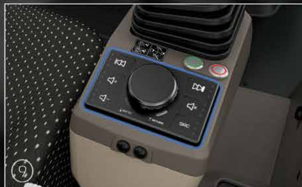
Кнопка управления интерфейсом Орега, встроенная в сиденье (**)
