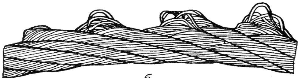
Рисунок 5. Выдавливание проволок прядей: а - в одной пряди; б - в нескольких прядях
