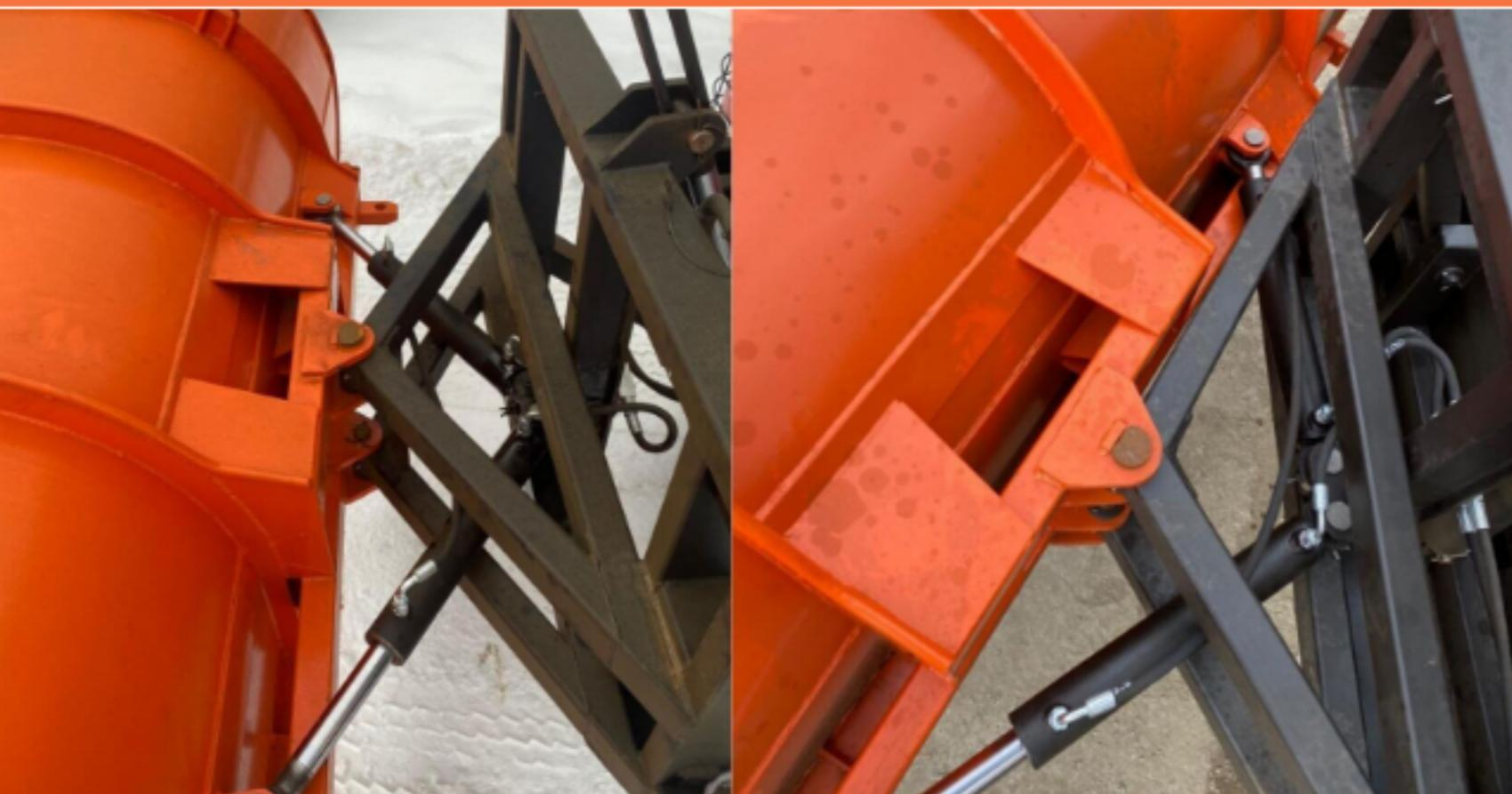
Возможна продажа и установка без гидропривода поворота
