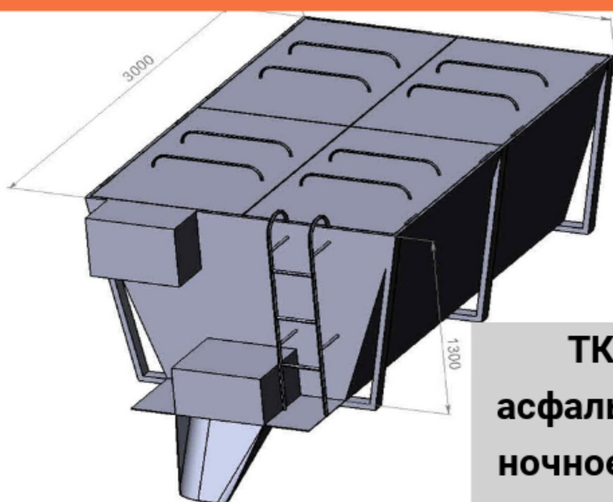
Бункер с пескоразбрасывающим устройством для равномерного распределения сыпучих материалов по дорогам общего пользования.
