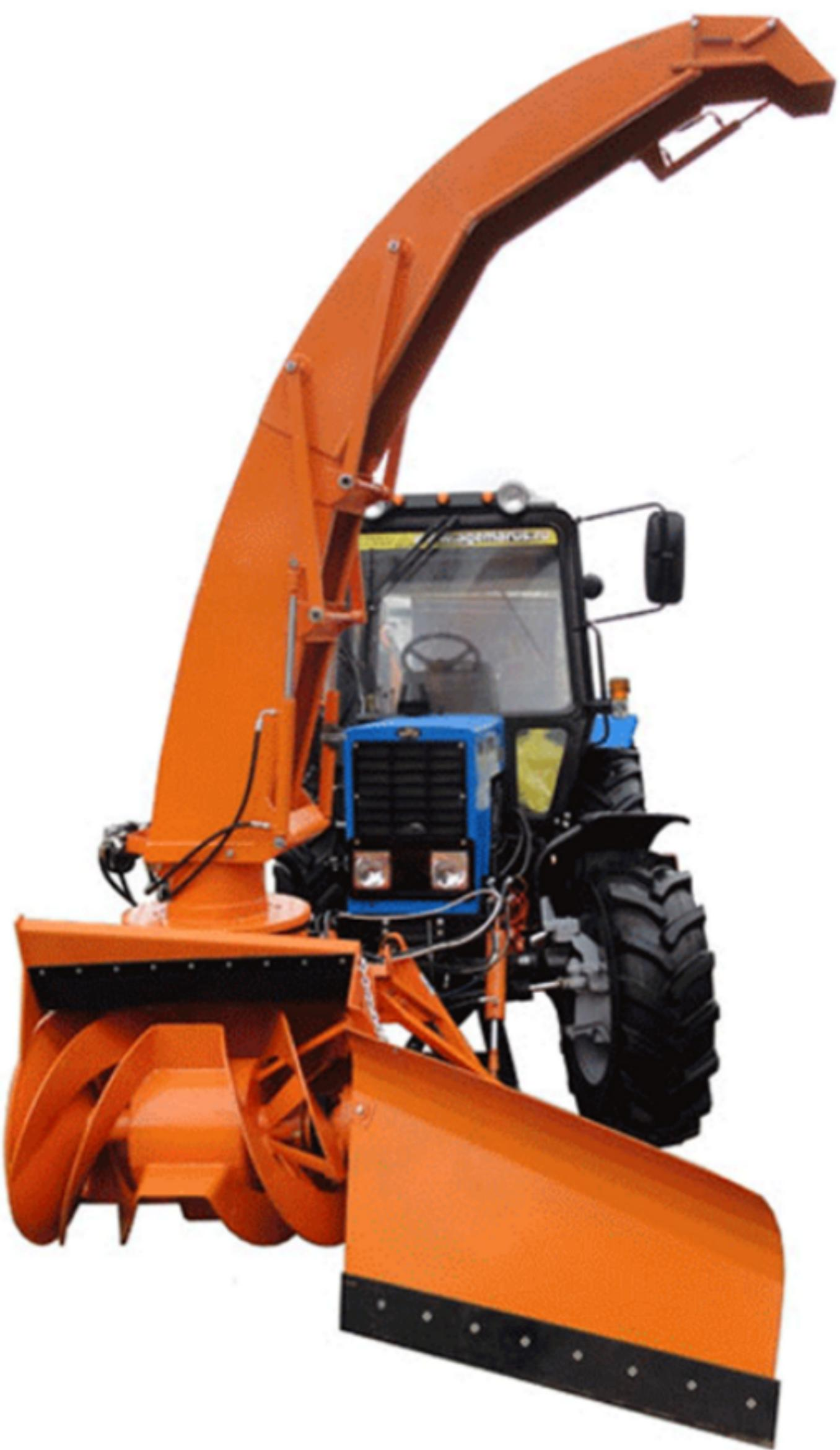
Снегоуборочная машина для тракторов типа МТЗ с механическим приводом. Предлагаемая снегоуборочная машина хорошо работает по жестким обледенелым обочинам, по очистке виадуков и по целине с высотой снега до одного метра. Отбрасывает снег от одного метра до двадцати но лучше всего подходит для города
