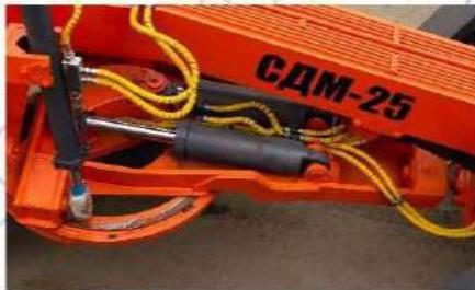
За счет треугольной геометрии повысилась жесткость рамы. Появилась возможность изменения угла реза отвала при помощи гидроцилиндра во время движения.
