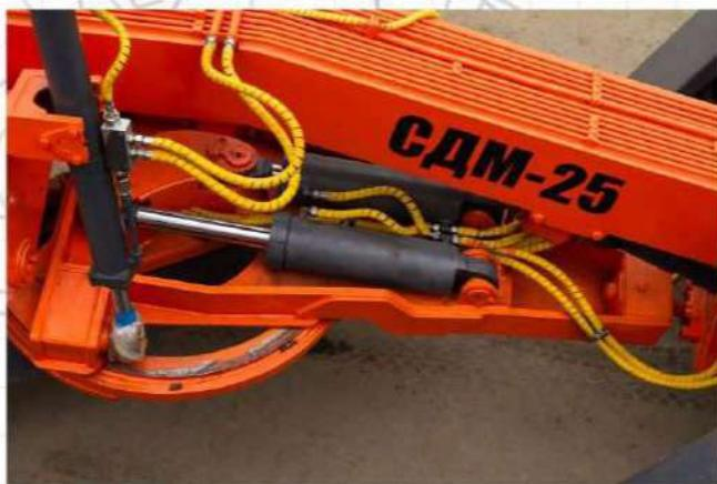
Плавающее положение отвалов - работа бульдозерного и среднего отвалов под своим весом, что позволяет копировать рельеф, не допуская повреждения основного твердого покрытия, увеличивает срок службы ножей, сохраняет рабочее оборудование при столкновении со скрытыми препятствиями, а при столкновении с инженерными системами позволяет снизить степень их повреждения (люки, коллекторы водоотведения), кроме того существенно облегчает работу оператора.
