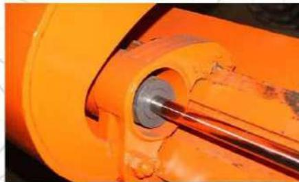
Расположенный в трубе гидроцилиндр позволил не только повысить жесткость опоры отвала, но и предохранить его от механического повреждения, а также организовать защиту РВД, расположение которых также претерпело изменения.
