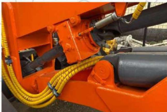
Для повышения ресурса работы карданных валов в качестве дополнительной опции предлагаем отключение привода переднего моста, который позволяет отключить вращение со стороны переднего моста.
