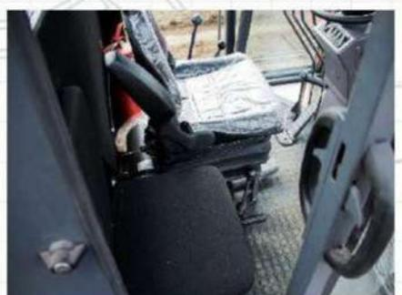
Трап оборудован поручнем для обеспечения безопасности при выходе из кабины.
