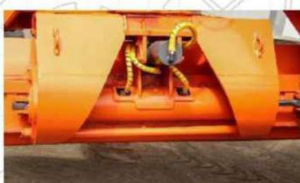
Поворотный круг вместо диагональных и поперечных раскосов, выполненных из трубы, получил полноценные усиители с элементами полусферы. За счет этого повысилась жесткость конструкции, что значительно снизило вероятность поломки.
