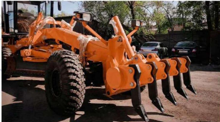
Передний рыхлитель предназначен для предварительной подготовки грунта. Рыхлитель может иметь 3 или 5 зубьев, в зависимости от выбранной модификации. Крепление унифицировано: возможна установка вместо бульдозерного отвала.
