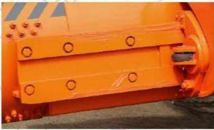
Появилась возможность замены направляющей отвала. Теперь при износе достаточно заменить несколько недорогих накладок, и работоспособность отвала будет восстановлена практически до нового состояния.
