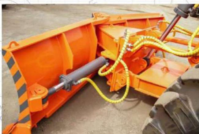
Путепрокладочное оборудование может быть установлено и на габаритной версии автогрейдера с сохранением общей ширины машины — 2550 мм (в сложенном положении).
