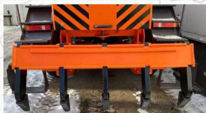
Мы существенно изменили конструкцию рыхлителя заднего расположения и теперь он имеет квадратное сечение с более жёстким креплением кликов. Используется для рыхления очень плотного материала, асфальта, льда.
