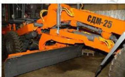
Учитывая многочисленные пожелания эксплуатантов, мы установили полусферические ножи, которые гораздо лучше себя зарекомендовали в работе. Края основного отвала полностью закрыты ножами, что позволяет не только защитить зеркало отвала, но и производить более широкий спектр работ с обочиной.
