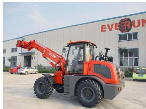
EVERUN имеют комфортную кабину с круговым обзором на 360 градусов. Для удобства работы оператора погрузчики оснащены гидравлической трансмиссией, джойстиком управления, тканевым сидением, обогревателем, автомагнитолой с МРЗ, камерой заднего вида. Все фронтальные погрузчики EVERUN поставляются с системой защиты от опрокидывания (ROPS) и системой защиты от падения объектов (FOPS).
